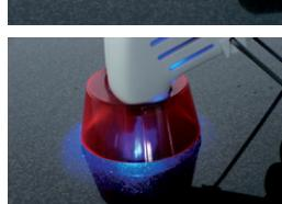
Mit AKELUX Sichtfolie/Oberflächenstrukturstempel\*\* bedecken und 60 s/cm<sup>2</sup> mit AKELUX LED-Powerlight\* aushärten.
