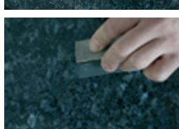
Leg het AKELUX siliconen slijplinnen op het polijstblok en schuur de beschadigde plek nat in, in de volgorde K2400-K3200-K4000. Deze stap is niet nodig bij het gebruik van een oppervlaktestructuurstempel\*\*.
