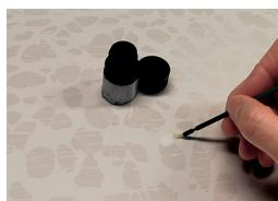
Bij keramiek kan de kleur van de scherven (body) sterk afwijken van de decor/toplaag kleur. Als dit het geval is dien je deze schade met een zeer dunne laag AKELUX Opaquing Agent te dekken. Deze laag dient vervolgens 60 seconden uitgeharden te worden met de AKELUX LED-Powerlight\*.
