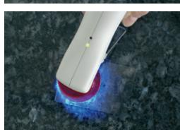
Mit AKELUX Sichtfolie/Oberflächenstrukturstempel\*\* bedecken und 60 s/cm<sup>2</sup> mit AKELUX LED-Powerlight\* aushärten.
