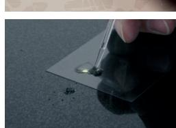
AKELUX Filler transparent liquid mit verschiedenen farbigen AKELUX Fillern mischen (max. 50% Farbanteil) und an die Objektfarbe anpassen.
