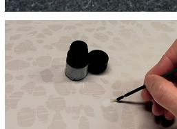
Keramische Scherben, die sich stark vom Decor unterscheiden, können nun mit einer sehr dünnen Schicht AKELUX Opaquing Agent überdeckt werden. Diese Schicht muss im Anschluss 60 Sekunden mit dem AKELUX LED-Powerlight\* ausgehärtet werden.
